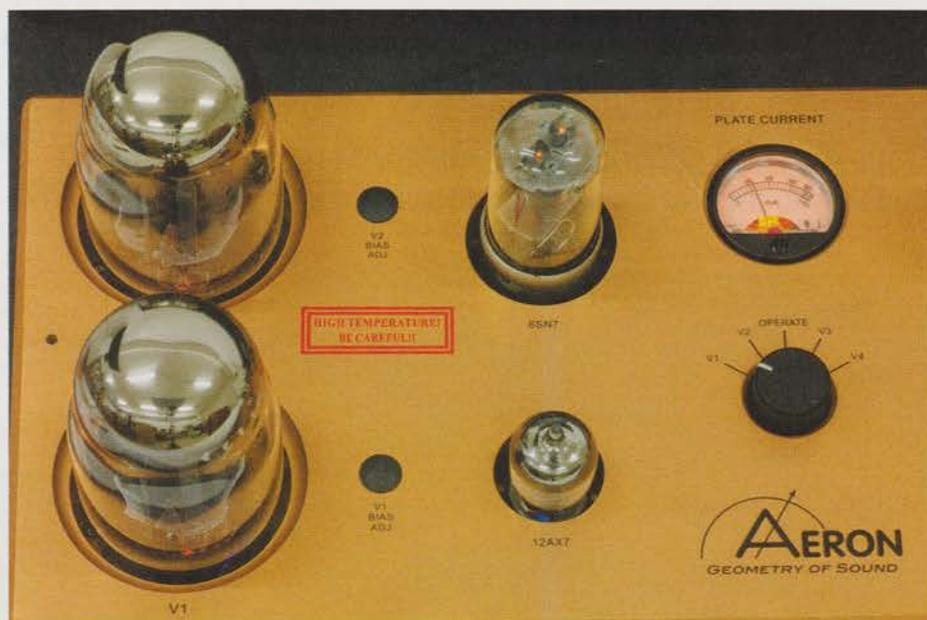
L'apparecchio consente di utilizzare diverse tipologie di valvole; è richiesto solo di effettuare la corretta regolazione del bias, verificabile attraverso lo strumento posto superiormente, agendo su quattro potenziometri accessibili rimuovendo i piccoli cappucci neri.
