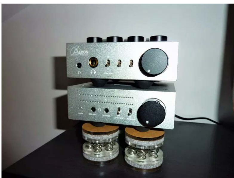
L'Aeron C-101 & P-101 che ho dotato di quattro piedini antirisonanza della Oehlbach e di altrettanti smorzatori di risonanza della Douk Audio.
